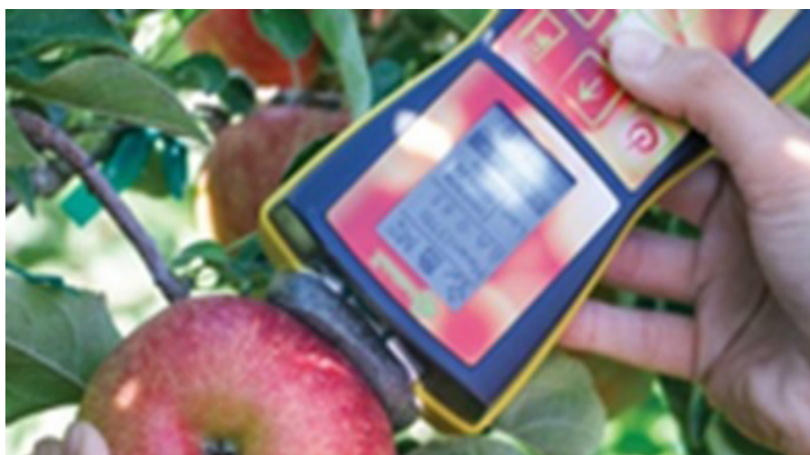
Bild 1. DA-mätare kan användas i fält för att fastställa den optimala skördetidpunkten, i packeriet för en noggrann sortering efter mognadsgrad, och under kyl- respektive ULO-lagring för att bestämma fruktens lagringspotential.
