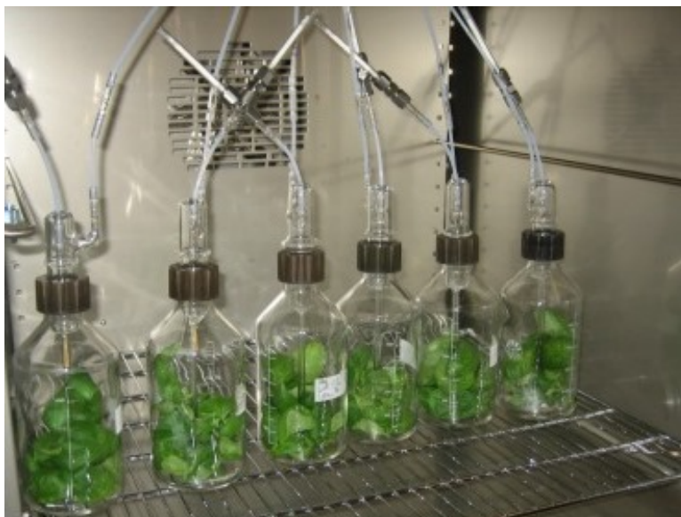
Figur 1. Basilikablad i provtagningsflaskor med headspace-adaptrar och adsorbentrör.
